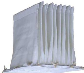
Der Taschenfilter ist aus Flies genäht. Die einzelnen Taschen sind keilförmig mit **Zwirn** in die Einfassung genäht, die zur **Befestigung des Filters an den Andruckrahmen** dient.
