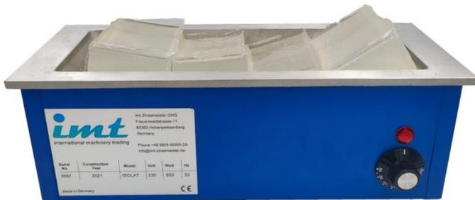
Sia per lo stoccaggio che per la spedizione, i bordi di taglio degli utensili di alta qualità e delle parti di precisione sensibili devono essere protetti dai danni meccanici e dalla corrosione.
